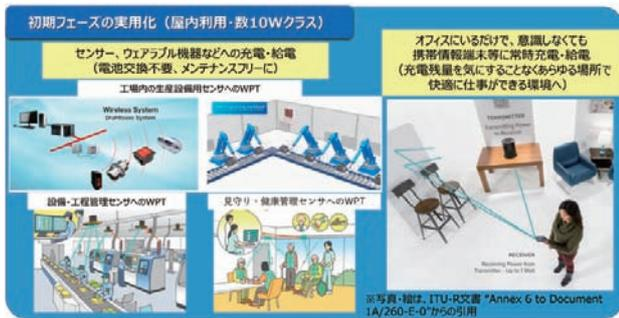
図6. マイクロ波帯空間伝送WPTの初期段階 (第1ステップ) の実用化形態 (9)
