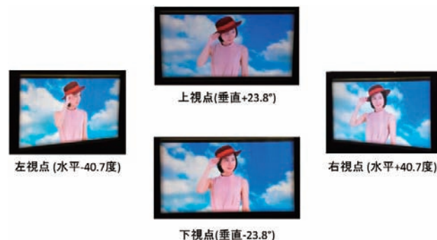
■図6. 視点追従インテグラル3Dディスプレイを各視点位置から観察した場合の画像
