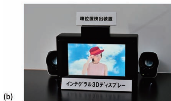
■図5. 視点追従インテグラル3Dディスプレイの (a) 構成と (b) 外観写真
