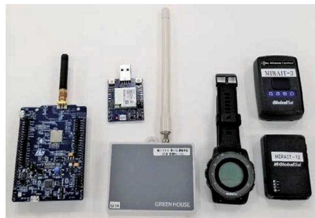
■ 写真2. LoRaWAN電波特性調査に利用したエンドノード機材 (一部)
