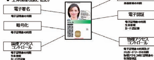
■ 図3. PIVのICカードの概要
