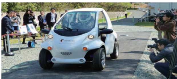
(b) バッテリーレスEVが連続給電走行
