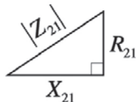
■図3. 伝達インピーダンスの直角三角形
