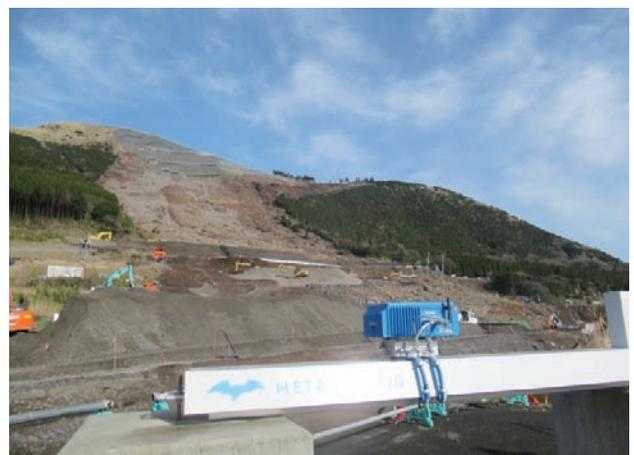
■写真1. 南阿蘇村立野地区に設置したGB-SAR装置
