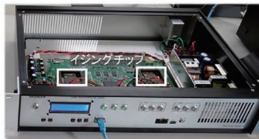
(b) 試作したイジングコンピューティングノード
