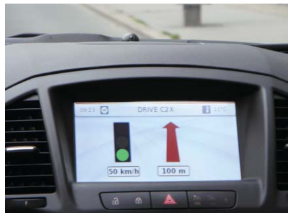
写真6. 50キロで走行すれば100m先の信号を青で通過できる
