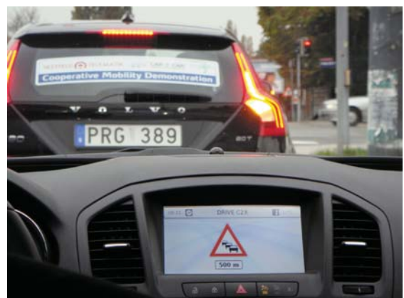
写真7. 前方車両のブレーキ情報が自車に表示される。
